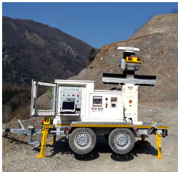
Радару IBIS-Rover присущи высокая мобильность и простота установки
